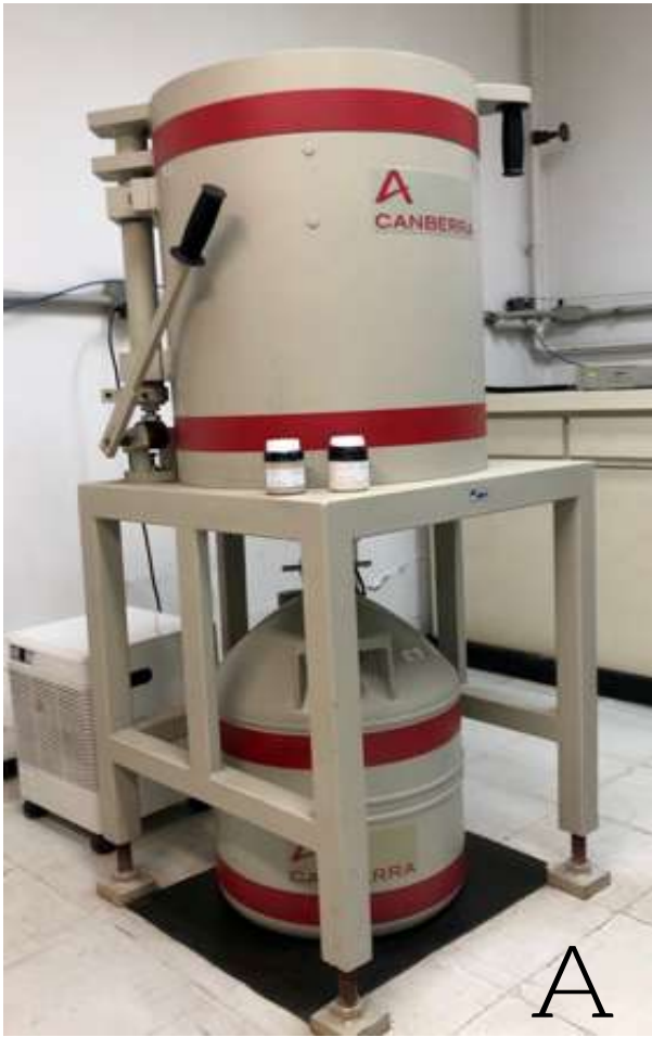
FIG. 3 – Detector de radiação gama de germânio hiperpuro do Laboratório de Radiometria Ambiental do Ipen (a). Detalhe da parte interna com a amostra posicionada (b). (fotos do autor).
